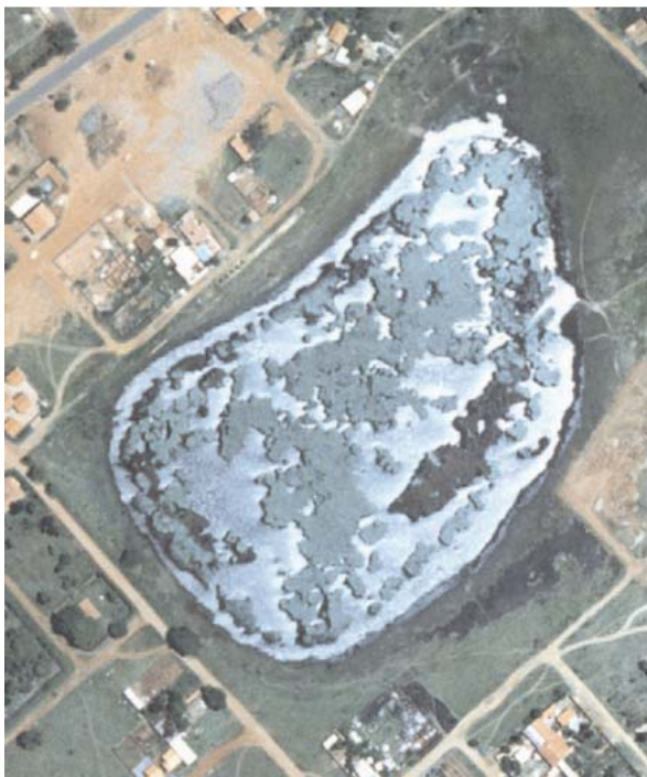
Figura 3: Visão aérea da Lagoa Itatiaia antes do início das intervenções em 2002 (Fonte: GEOMORENA, 2000). A Lagoa estava em um avançado processo de eutrofização, além disso, nota-se a presença de residências próximas a água, as quais despejavam esgoto clandestino.
