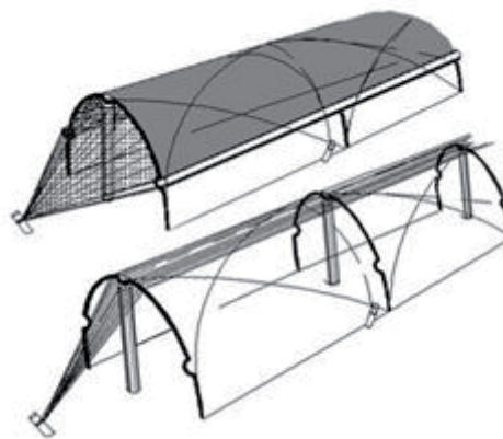
Figura 1 - Estrutura de um túnel baixo. Fonte: Embrapa (2010).
